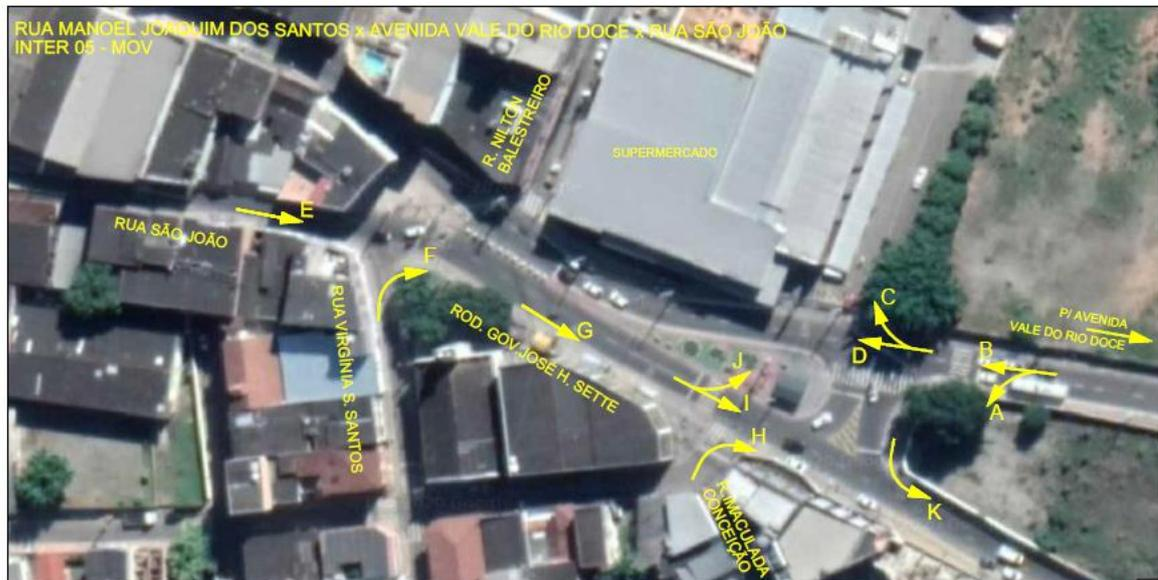
Figura 25D: Movimentos encontrados na Interseção 05.
